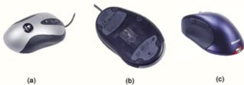
圖 4 (a) 光學滑鼠 (b) 反轉的光學滑鼠 (c) 使用藍牙技術的無線滑鼠
