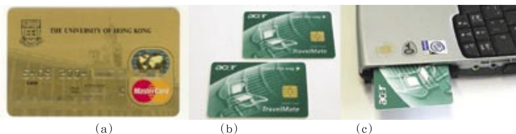
圖 20 (a) 在背面有一條磁帶的信用卡 (b) & (c) 為鑒別筆記簿型電腦用戶而設的智能卡
