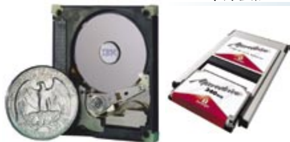
圖 13 Microdrive (左) 內部 (右) 外貌
