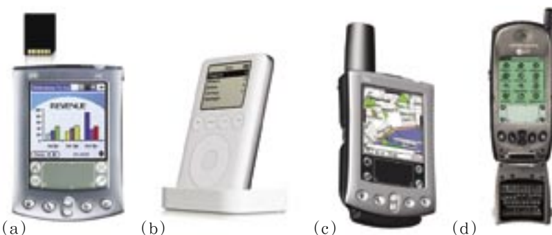
圖 2 (a) 有彩色顯示屏及使用smartMedia 記憶卡的袋裝電腦 (b) 蘋果電腦公司出產的 iPod (c) 設有全球定位系統的袋裝電腦 (d) 智能手機
