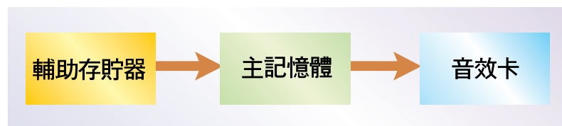
圖 6 聲音經過硬件的內部傳輸。
